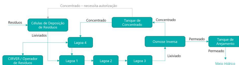
Figura 4 – Diagrama representativo do sistema de tratamento de lixiviados implementado na RSTJ (Fonte: Fig. 3-1 do Estudo de Gestão dos Lixiviados do Aterro sanitário RSTJ, 30/03/2023)
