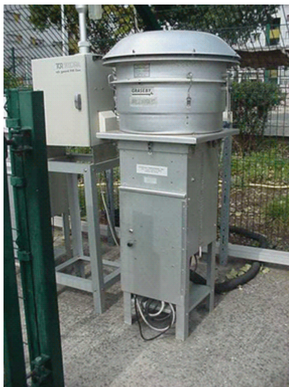
Figura 101: Amostrador de Alto Volume Andersen ® com cabeça de amostragem PM 10 utilizado na campanha
