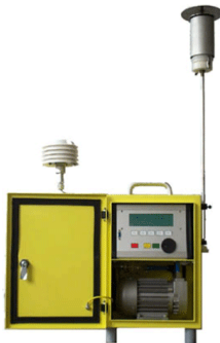
Figura 89: Amostradores de PM 10 de Baixo Volume (LVS) utilizados (Derenda, 2004)
