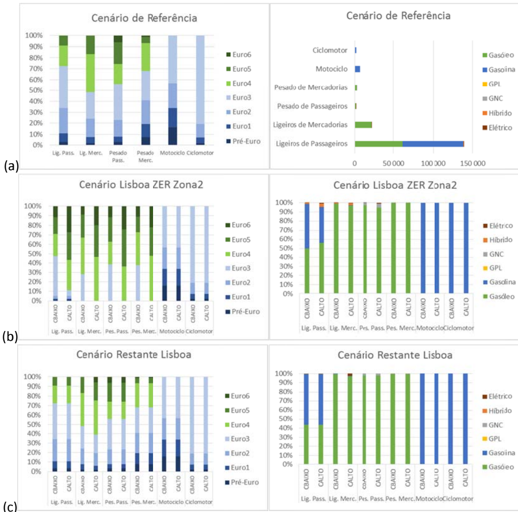
Figura 73. Frotas consideradas no Cenário de Referência (a), Cenário Base (b) e Cenário Projetado (c), para o concelho de Lisboa (na ZER Zona 2 e restante concelho): distribuição por categoria de veículo, distribuição por norma tecnológica e número total de veículos por categoria e combustível
