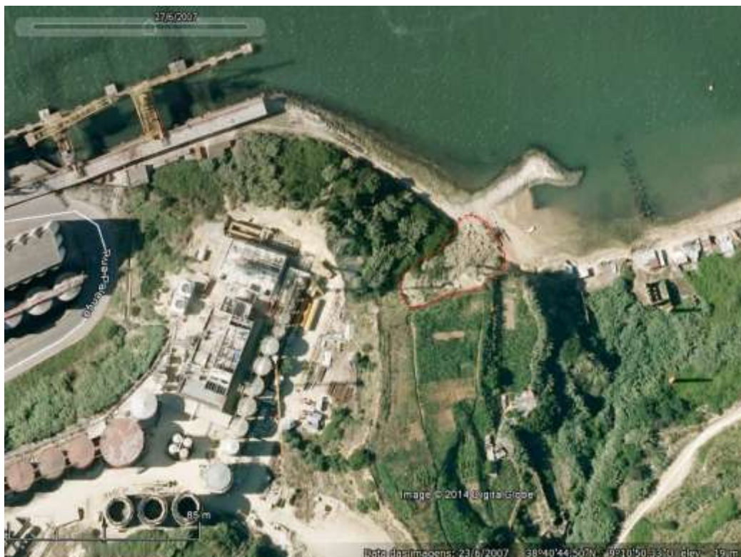
Escorregamento na arriba, provavelmente ocorrido entre 2005 e 2007.
