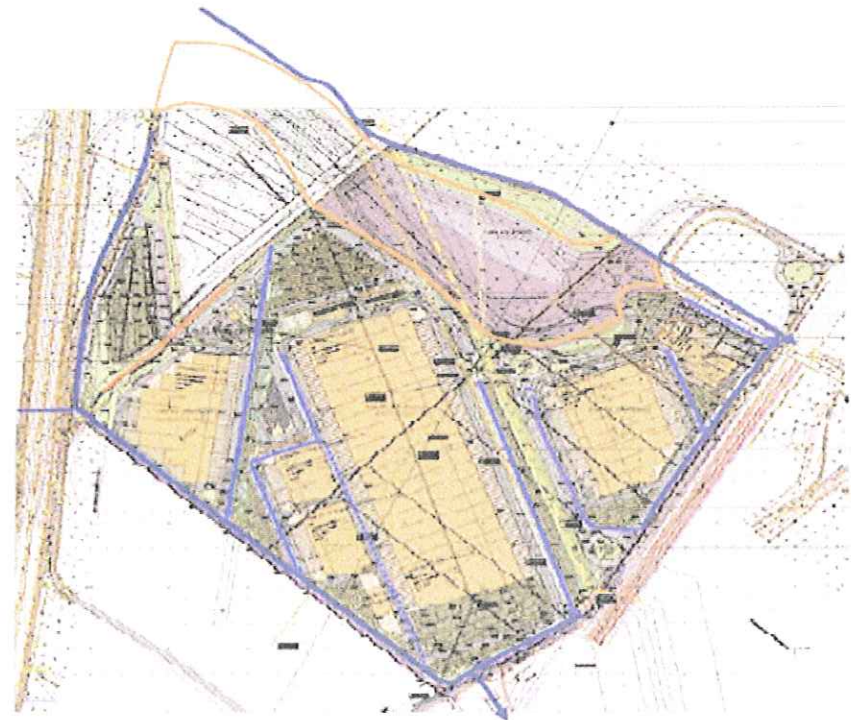
Figura 2 - Esquema da rede hidrográfica a intervir e da rede de drenagem interna da Plataforma Logística da Castanheira
