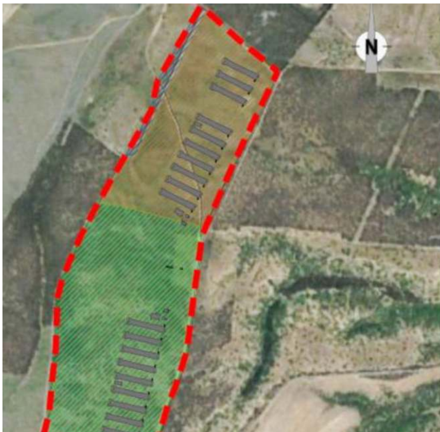
Figura 3: Limite da propriedade, a tracejado vermelho, edifícios a construir a cinzento (núcleo Norte e núcleo Sul) cada um com 10 pavilhões e, edificação no extremo Sul do terreno correspondente à nitreira.
