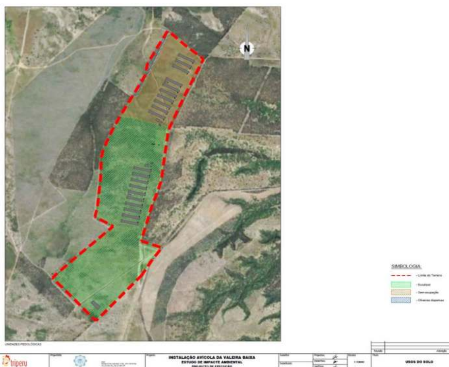
Figura 3: Limite da propriedade, a tracejado vermelho, edifícios a construir a cinzento (núcleo Norte e núcleo Sul) cada um com 10 pavilhões e, edificação no extremo Sul do terreno correspondente à nitreira.
